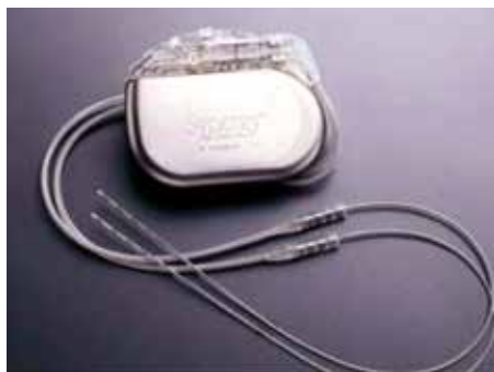
Obr. 1. Přístrojový set k SCS: generátor, prodlužovací kabely a perkutánní elektrody
